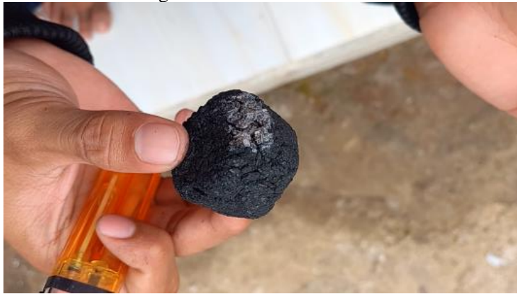
Gambar 2. Uji Coba Pembakaran Arang Briket Kulit Singkong (Dokumentasi Pribadi, 2023)
